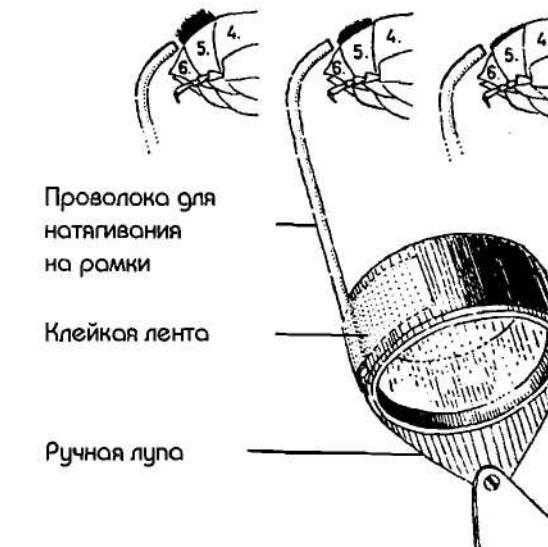
Рис. 40. Измерение длины волосков по пастору Херольду (объяснения в тексте).
