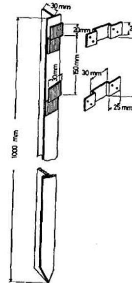
Рис. 33. Сваи из профилированного (таврового) железа с крючками для крепления улейков позволяют легко устанавливать их почти на любой почве.
